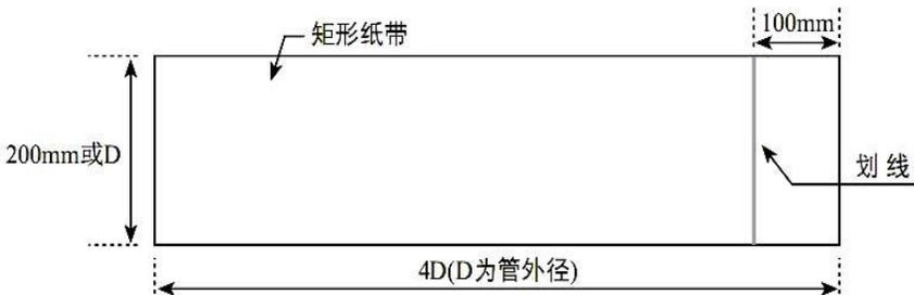
②将定位纸缠绕在表面已清理干净的管道上，注意必须把纸两边互相重合对齐，才能使所划的线与管轴相平行；
